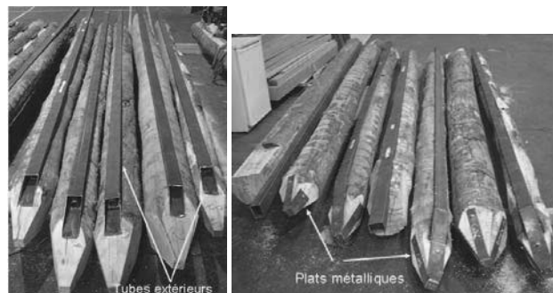
Figure 2. Tubes extérieurs dans la saignée et protection de la pointe
