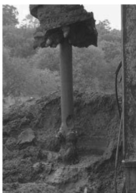
Figure 1. Tube plongeur et dents en bout de l'outil d'attaque.
