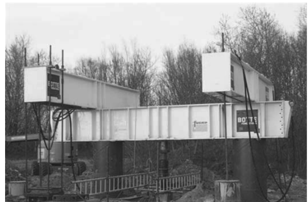
Figure 4. Dispositif d'essais de chargement utilisé à Loon-Plage
