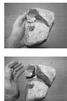
Figure 6. Gros granulats de STV récupérés après essai triaxial.
