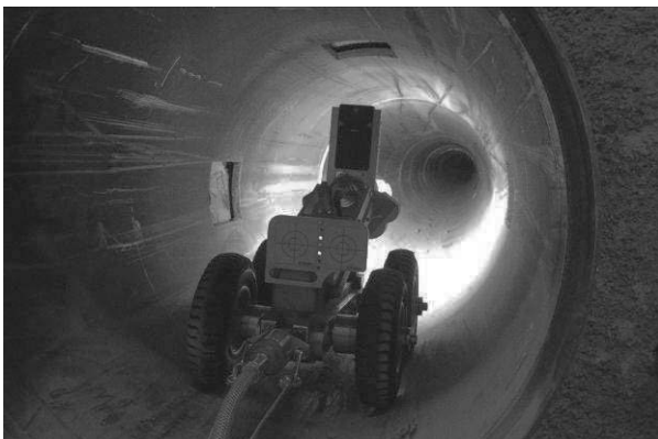
Figure 3. Robot d'auscultation vidéo en tête d'alvéole chemisée.
